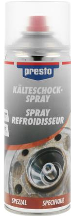
presto Kälteschock-Spray ist ein hochwirksames Hilfsmittel zum Lösen festgerosteter oder gepresster Verbindungen z.B. Schrauben, Muttern, Bolzen, Kurbelwellen. Spezielle Inhaltsstoffe erzeugen auf dem verrosteten Werkstück einen kurzfristigen "Kälteschock" (-50°C), der eine Schrumpfung bewirkt.
