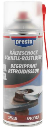
presto Kälteschock-Rostlöser ist ein hochwirksames Hilfsmittel zum Lösen festgerosteter Bauteile durch Erzeugung von lokalen Abkühlungen z.B. bei Schrauben, Muttern, Bolzen, Kurbelwellen. Spezielle Inhaltsstoffe erzeugen auf dem verrosteten Werkstück einen kurzfristigen "Kälteschock" (-30°C), der eine Schrumpfung bewirkt und gleichzeitig das Eindringen der schmierenden Bestandteile ermöglicht.
